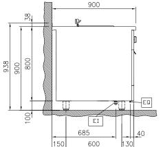
Electrical inlet (power) Equipotential screw
